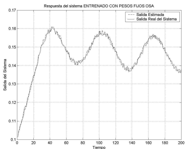
Figura 3: Respuesta del modelo entrenado con pesos fijos, y simulado con 5% de ruido OSA.
